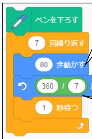
辺の数が多くなると、作図する図形がステージの外側にはみ出してしまう。動かす長さを修正する必要がある。
